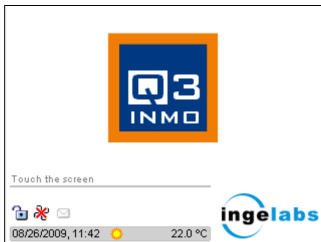
La pantalla de inicio muestra información sobre el estado de algunos de los componentes del sistema (subsistema de seguridad, climatización y mensajes), así como la fecha y la hora actuales, si es de día o de noche según el reloj astronómico, y la temperatura interna del equipo.
