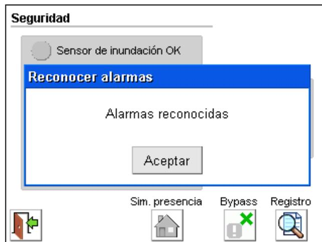
La función de "bypass" permite anular temporalmente la seguridad técnica. Cuando se habilita el *bypass*, el sistema desactiva las salidas de alarma y deja de monitorizar las entradas. Al deshabilitar el *bypass*, el sistema vuelve a monitorizar las entradas de alarma. Ambas acciones quedan registradas en el registro de eventos.
