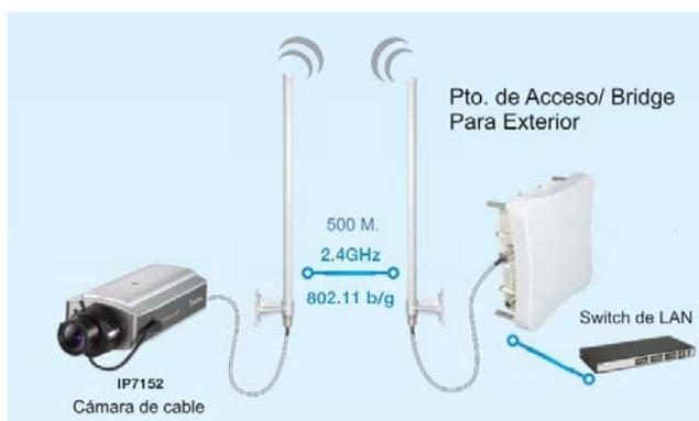
El Punto de Acceso/Bridge VIVOTEK Ref.:AP5822, tiene un diseño especialmente realizado para la instalación en exterior. Su resistencia a condiciones atmosféricas duras, permite su situación en tejados, mástiles, torretas de comunicaciones,... en definitiva en ubicaciones libres de obstáculos que permitirán mejorar las comunicaciones llegando a un radio de alcance de hasta 500 m. respecto a la
